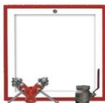
Compuesta por marco-contramarco IPF-40 (para empotrar) ó Cofre IPF-40 (para superficie o empotrar) metálico pintado en rojo de medidas **645 x 590 x (300) mm** con puerta pintada para cristal (no incluido) y cierre de cuadradillo de 8 mm. Bifurcación 45 mm. con válvulas, Entrada 2 1/2" x 2 Salidas de 45 mm. tipo barcelona UNE-23400 en aluminio estampado, con tapones. Y Válvula de sección de latón de 3".
